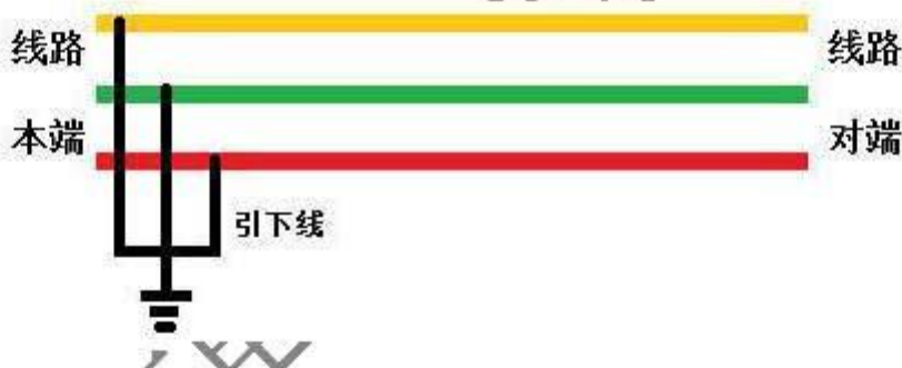
图 6-3 将被测线路本端引下线接地
